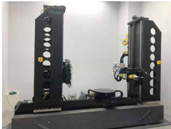
図 2 使用装置外観（X 線 CT）
