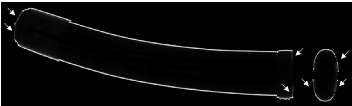
図7-3 表面定義を表面からマイナス方向に設定した断層画像 (輪郭線:定義面 左:横断面 右:縦断面)
